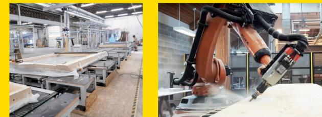
**Automatische Produktionslinien** im Holzbau unter Einbindung von Industrierobotern (Wand, Decke und Dach)
